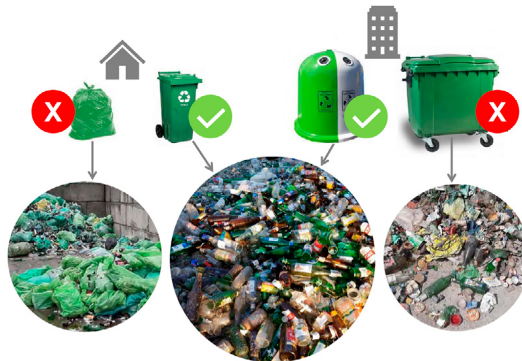
Rysunek 19 Różnice jakości selektywnie zebranej stłuczki szklanej w zależności od rodzaju stosowanego pojemnika
